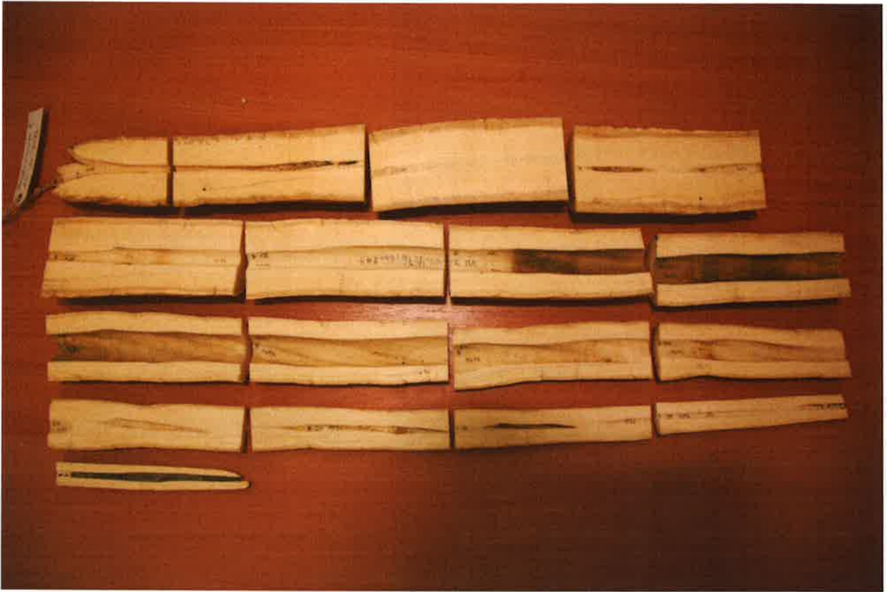
Fig. 1. Narhvalstødtand fra Vestgrønland halveret på langs og skåret i 17 dele. Klar til analyse med metoderne XRF og Laser Ablation ICP-MS.
